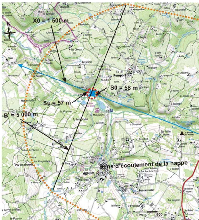
Figure 9 : Zone d'appel et isochrone 50 jours pour le forage du Moulinot (Extrait du rapport HEH 2018)
